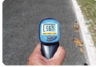
アスファルト表面温度 56.7 °C 9月10日測定
