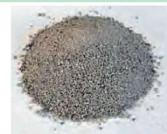
鉄鉱石から鉄を取り出す際に発生する副産物です。有機不純物を含んでおらず、ひび割れの原因となるアルカリ骨材反応が生じることのない、安定した骨材です。
