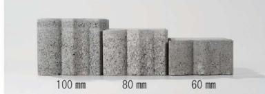
従来の80mm ILBと比べて、荷重伝達率は約1.3倍、さらにブロックの移動量は1/3以下。
