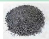
ステンレスを製造する際に発生する副産物です。JIS A5005(コンクリート用碎石及び碎砂)の品質基準を満たしています。
