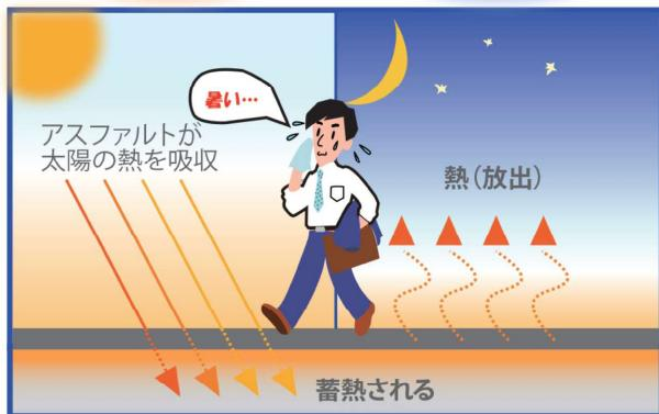
■ 昼間地表に降り注ぐ太陽光は、熱エネルギーとしてアスファルト舗装に吸収されます（蓄熱）。
